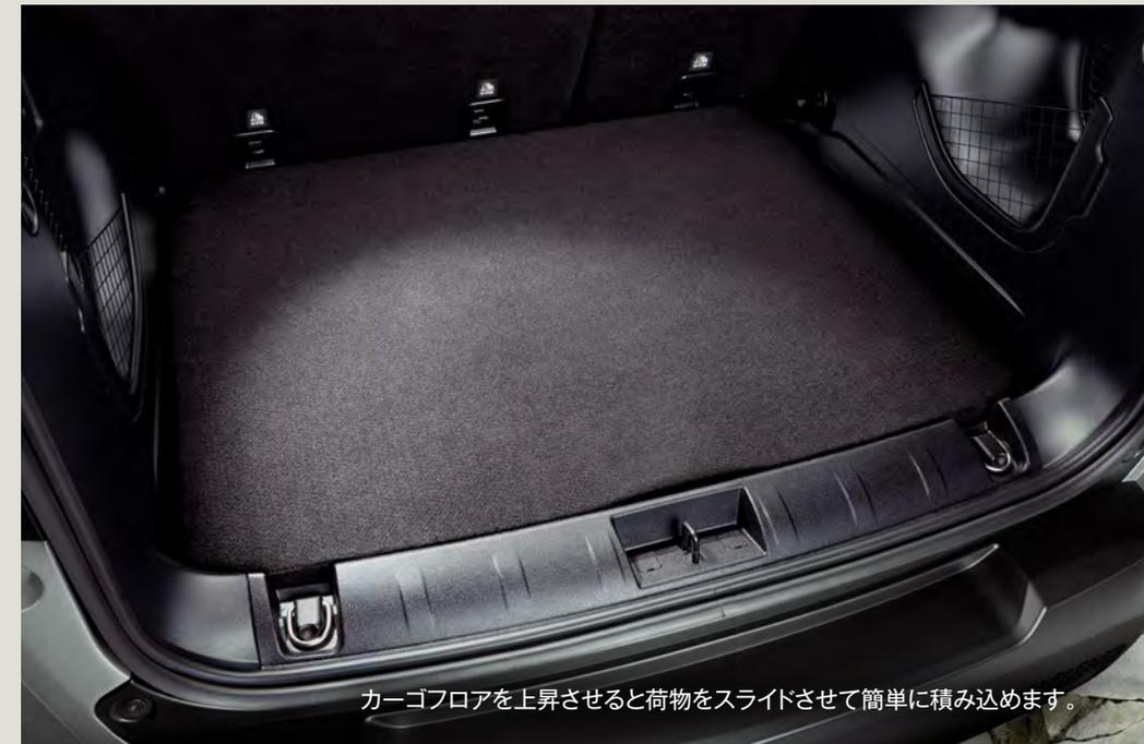
カーゴフロアを上昇させると荷物をスライドさせて簡単に積み込みます。
