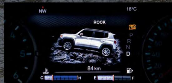
**ROCK (岩)** ロッキングリアディファレンシャルの採用により、たくましい低速4x4走破性を実現。世界で最も険しいとされるオフロードを難なく走破します。
