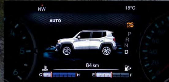
**AUTO (オート)** 日常走行に最適な標準モード。4xeでは普段はガソリンエンジンで走行し、必要に応じて電気モーターに自動で切り替えます。
